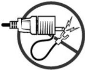
3. Si el cable de alimentación de CA tiene un cable de conexión a tierra de color verde para la conexión a una toma de alimentación eléctrica, conecte el conector metálico de conexión a tierra a la conexión a tierra de la toma de corriente (consulte la siguiente ilustración):
